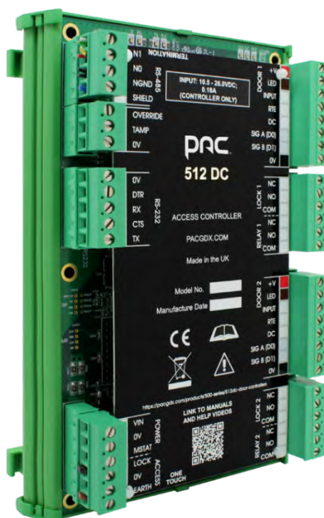
Figuur 8 - PAC 512 DC-controller met DIN-installatie
